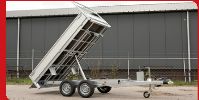
5-traps, zeer sterke cilinder, met 48° kiphoeck (geschikt tot 6100 kg)
