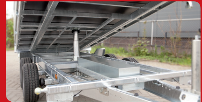
Pomp en accu afgedekt in het chassis
