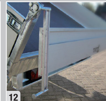
5-stufiger, sehr starker Zylinder, Kippwinkel 48° (bis 6100 kg)
